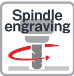
刃物が回転して削って彫刻します。太い文字を彫刻したり深く彫り込む事が出来ます。切抜き文字などやインク入れ作業の必要な彫刻方法もこの彫刻方法になります。『Magic10』『Magic30』『Magic70』『MagicF30P』『MagicF300P』が対応可能な機種になります。貴金属製品、アクリルなどの樹脂材料や木材、WAX、簡易治具等でよく用いられるポリアセタール等に有効な彫刻方法です。
