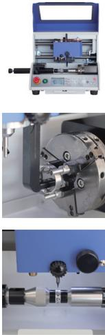
リングの内側、外側の彫刻をはじめ、バングルやシリンダーの内側、外側の彫刻が可能に。成形材料、ミーリングリング、深堀切削、彫刻など「Magic-M10」は、切削加工で金属を直接切削して指輪の彫刻をすることが出来ます。深彫切削、透かし切削、ミル切削などが数値を入力することにより素早くそして簡単に行えます。「Magic-M10」は「MR」の後継機種としてリニューアルしたモデルになりますが「MR」はリングの彫刻に特化したケガキ彫刻の機能のみを搭載した機種でした。本機種「Magic-M10」は回転モーターを搭載し、筒形状の対象物に対して切削加工が可能となり、本体の彫刻許容範囲もワイドサイズが広がったためペン先の彫刻も可能。他の機種には無い”オイル循環機”を標準装備しているため金属を切削する際の発熱にも対応出来るようになりました。
