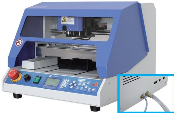
「Magic-F350」は切断・切削作業に特化した「Magic-F300P」のカスタムモデルです。「Magic-F300P」のボディにクーラントシステム（オイル循環冷却システム）を追加し、モータ回転数も 20,000r.p.m。スピンドルのツール差し込み口も、多くのエンドミルに対応できるようにコレットタイプにカスタムしたモデルです。
