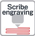
ケガキ彫刻はダイヤモンドチップなどで引っ掻きながら彫刻していきます。ツールにダイヤモンドを使用しますので、金属に対して非常に綺麗で光り輝くような彫刻を可能にします。ヘッド部にスプリングを内蔵しているため、右記図のようにゆるい凹凸でも彫刻することが可能です。初心者方でも刃などを折る事なく、使いやすい彫刻方法です。ダイヤモンドチップの為、速い彫刻速度に対応し金属に限らず、多くの素材に彫刻することが可能です。
