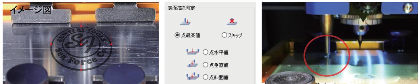
上図イメージの様に1点測定時は彫刻彫刻エリアの中心高さ、2点測定時は彫刻エリアの左右高さ、4点測定時は彫刻エリアの左右上下の高さを計測し、計測した点数の平均値を原点とします。
