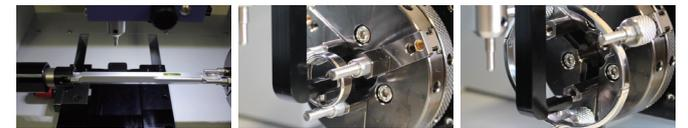
ボールペン固定時 対象形状に合わせた固定チャックピン標準付属
